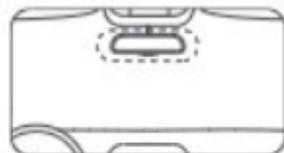
Napomena: Elektrostaticku naljepnicu obavezno zalijepite na ravni i glatki dio vjetrobranskog stakla, čvrsto je pritisnite i izbjegavajte lijepljenje na rub filma vjetrobranskog stakla kako biste spriječili njeno otpadanje.
